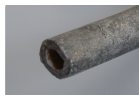
Waterleiding van lood (bron: Oasen)
